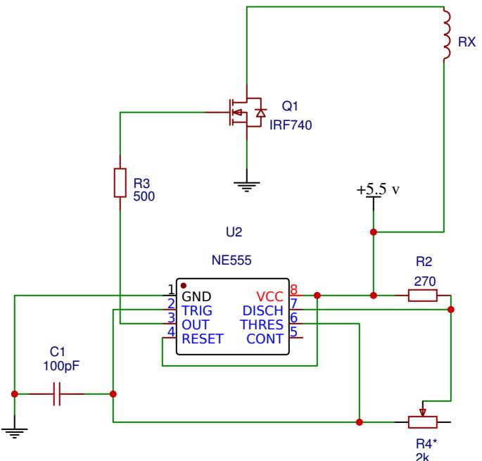
\*R4 es una resistencia variable está ajustada a 1.05k para obtener la frecuencia de 5.5 kHz. Si queremos otra frecuencia debemos ajustar esta resistencia. Debemos tener en cuenta que los valores son válidos con la alimentación del circuito 5.5v. Cualquier cambio en el voltaje cambia la frecuencia!!
